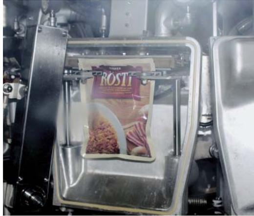
*Links: Die weit geöffneten Beutel werden mit Röstibefüllung befüllt.*
