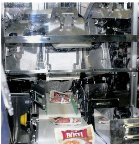
*Nach dem Vakuumieren und Verschiessen fallen die Beutel aus der geöffneten Vakuumkammer direkt auf ein Förderband, welches die Beutel zum Autoklaven transportiert.*
