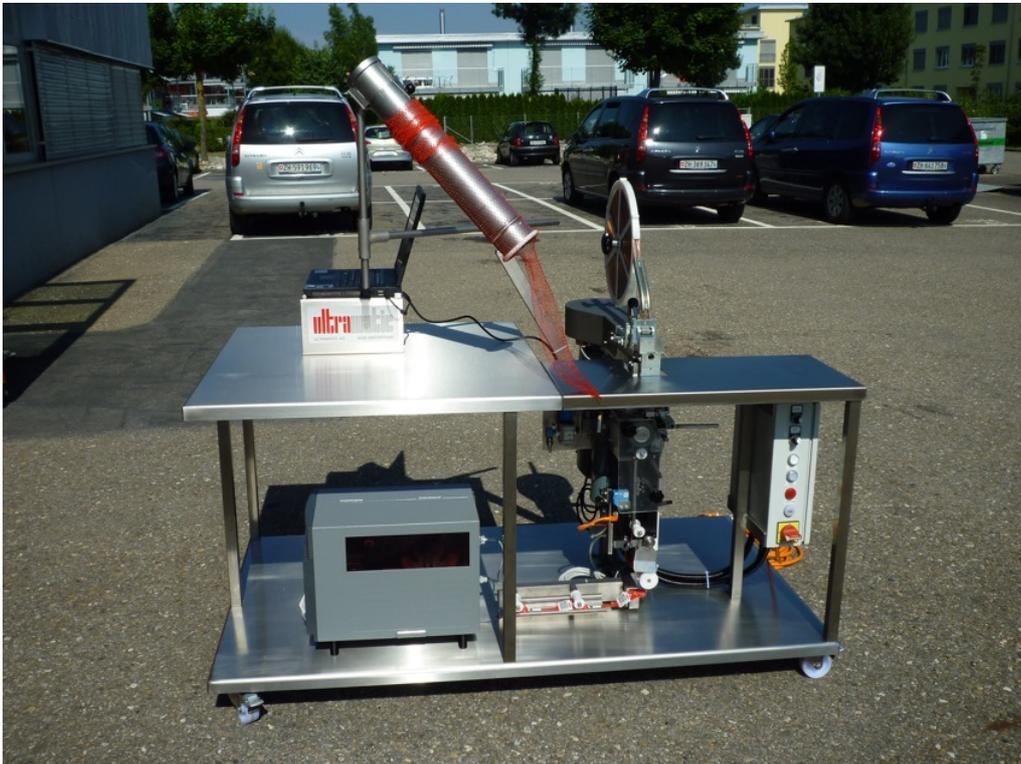
Gesamtansicht mit Steuerung, Arbeitstisch, Klippkopf und Netzrohr.
