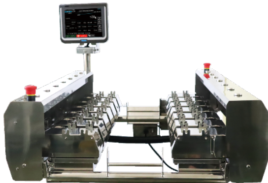
Bild: Yamato TSD-N3 nach Ausbau der Wiegebänder
