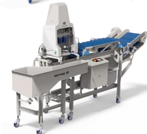
Die halbautomatische Stanzmaschine FS-1500 schneidet Obst und Gemüse zu Ecken, Scheiben oder Sticks. Die Maschine ist für das Schneiden von zwei Produkten pro Zyklus ausgelegt. Das Produkt wird von Hand in die Halter eingesetzt. Um anschließend der direkt motorbetriebene Zyklus zu starten, müssen mit beiden Händen gleichzeitig die an der Maschinenseite befindlichen Starttaster gedrückt werden. Das geschnittene Produkt wird auf dem Transportband kontinuierlich oder schrittweise abtransportiert.
