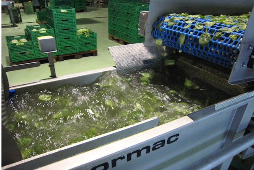
Waschmaschine 3,5 m lang mit starker Wasserzirkulation laveuse de 3,5 m longueur, avec écoulement d'eau forte
