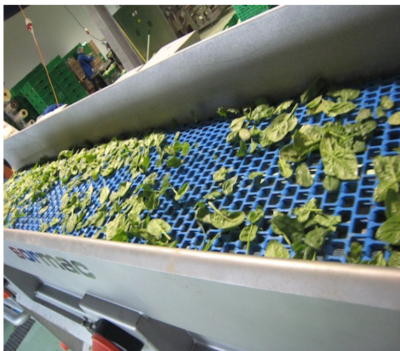
Klopfband - kleine Teile fallen durch die Maschen tapis battant - des petits pièces tombent par les mailles
