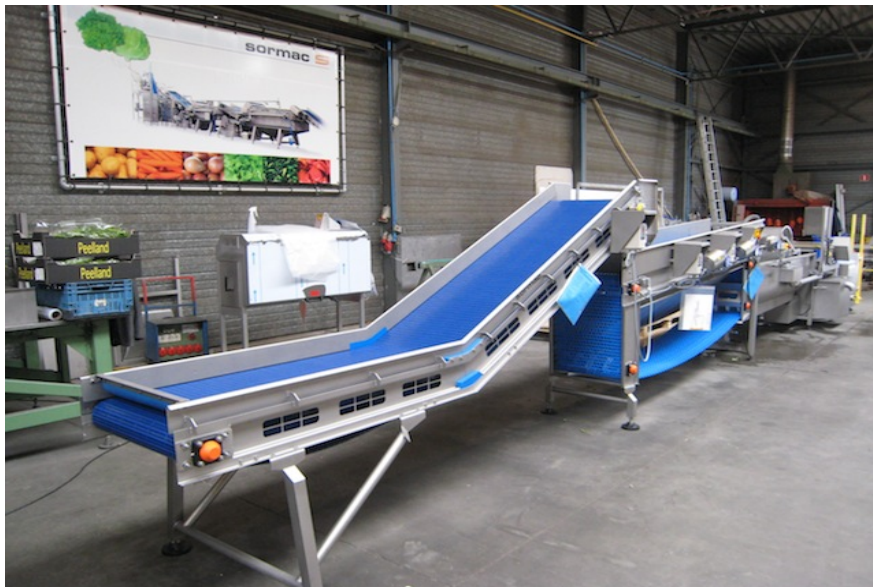
Verlese- und Beschickungsband tapis de séparation et d'alimentation
