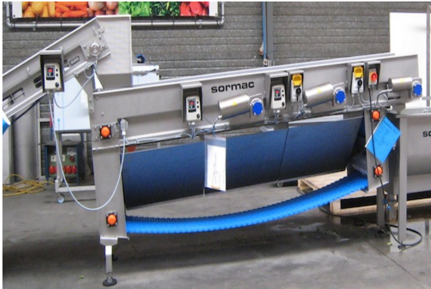
Klopfband mit Auslaufrutschen und 2 Excentermotoren mit stufenloser Geschwindigkeit tapis battant avec glissières et 2 moteurs à vitesse sans graduation
