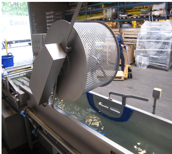
Motorisch angetriebener Kleinteile Separator filtre motorisé, pour éliminer des mouches et des coupes-fausses
