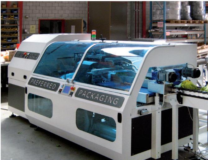
Seitenschweissmaschine mit Schrumpftunnel für offene Produkte
