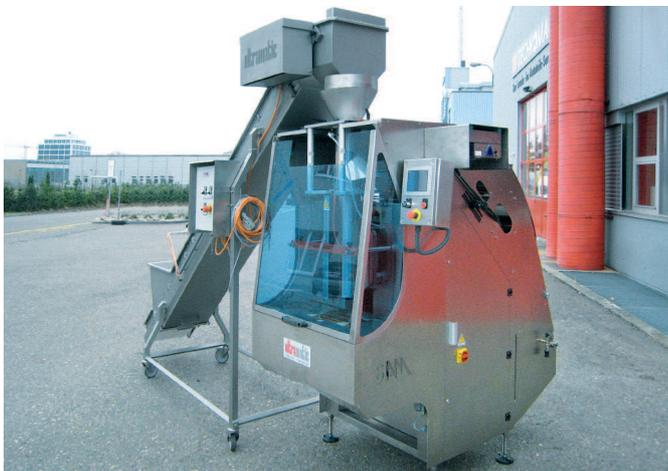
Schlauchbeutelmaschine mit Taktband
