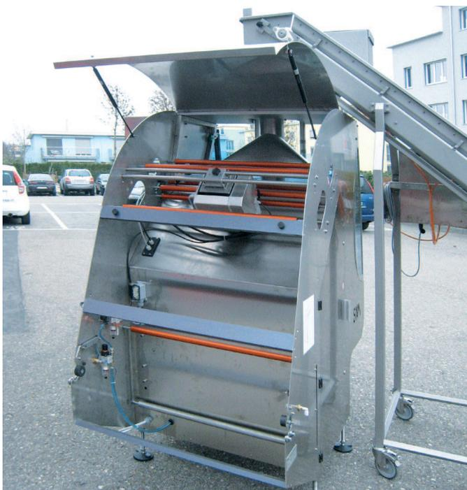
Schlauchbeutelmaschine mit Taktband
