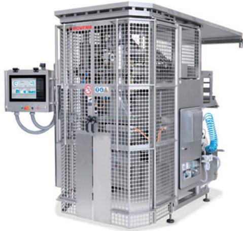
garantiert optimale Zugänglichkeit. Die Steuerungstechnik wurde komplett ins Maschinengehäuse integriert. Dabei ist der Schaltschrank komplett ausziehbar und erleichtert Reinigungs-, Wartungs- und Einstellarbeiten. Voll aufschwenkbare Doppelschutztüren bieten besten Zugang zum Arbeitsbereich der Maschine. Auch der Hüllstoffträger ist rundum zugänglich. Drucker, Etikettierer und Metallsuchgeräte sind platzsparend in die Maschine integriert.
