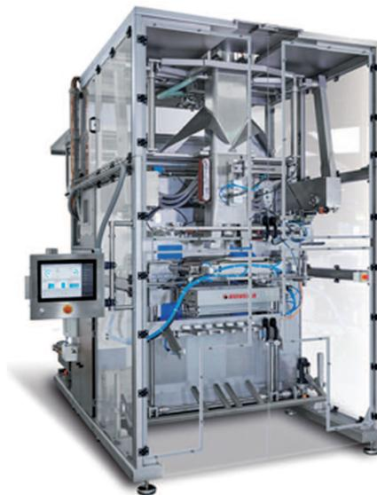
Kombiniert mit einer eigens dafür weiterentwickelten **Schnecken-Dosierwaage** können pulverige Produkte staubfrei und gewichtsgenau abgefüllt werden. Das Geheimnis vom staubfreien Abfüllen liegt beim Schneckendosierer, welcher mit einer speziellen Absaugvorrichtung ausgestattet ist. Dieser lässt sich für alle Rovema Schlauchbeutelmaschinen verwenden.
