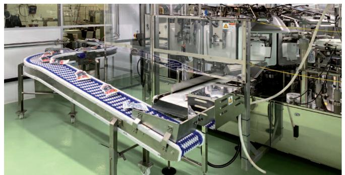
Dort werden die Beutel begast und verschweisst oder im Falle von Lake nur verschweisst. Nach dem Verlassen der rotierenden Kammern passieren die Beutel eine Yamato Kontrollwaage mit Metalldetektor und von dort gelangen sie in die Versandpackung.
