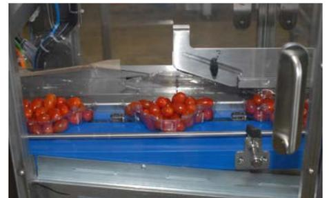
Andrückstation zum Verschliessen der Deckel: Ein pneumatischer Stempel drückt den Deckel auf die Schale.
