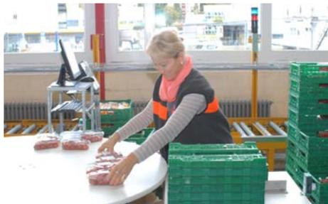
**Die Schalen laufen auf einen Rundtisch, von dem sie per Hand entnommen und in Mehrweggebinde eingesetzt werden.**
