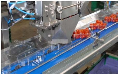
Spezielle Senktrichter in der Übergabestation, in der die Produkte von der Mehrkopfwaage in die Schalen gefüllt werden.
