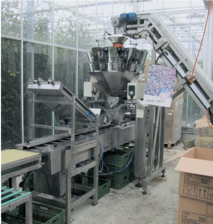
Die vollautomatische Anlage entstapelt Trays, wiegt Cherry-Tomaten ein und verschliesst die befüllten Trays mit einem Deckel.
